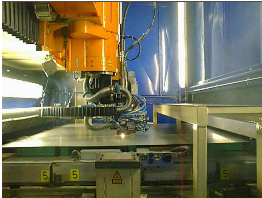
Bild 5: Inspector Sensoren zur Nahtverfolgung und Nahtinspektion integriert in die Arbeitsköpfe einer Thyssen Nothelfer Paletten-Conti-Laserschweißanlage zum Schweißen von nichtlinearen Nähten (mit freundlicher Genehmigung der Thyssen Krupp Stahl AG, der Thyssen Fügetechnik GmbH und der Thyssen Nothelfer GmbH)
