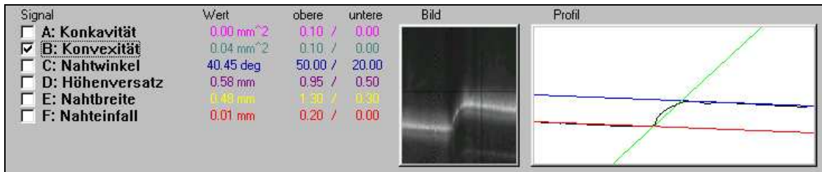
Bild: 8: Profil einer aufgewölbten Schweißnaht (Konvexität)
